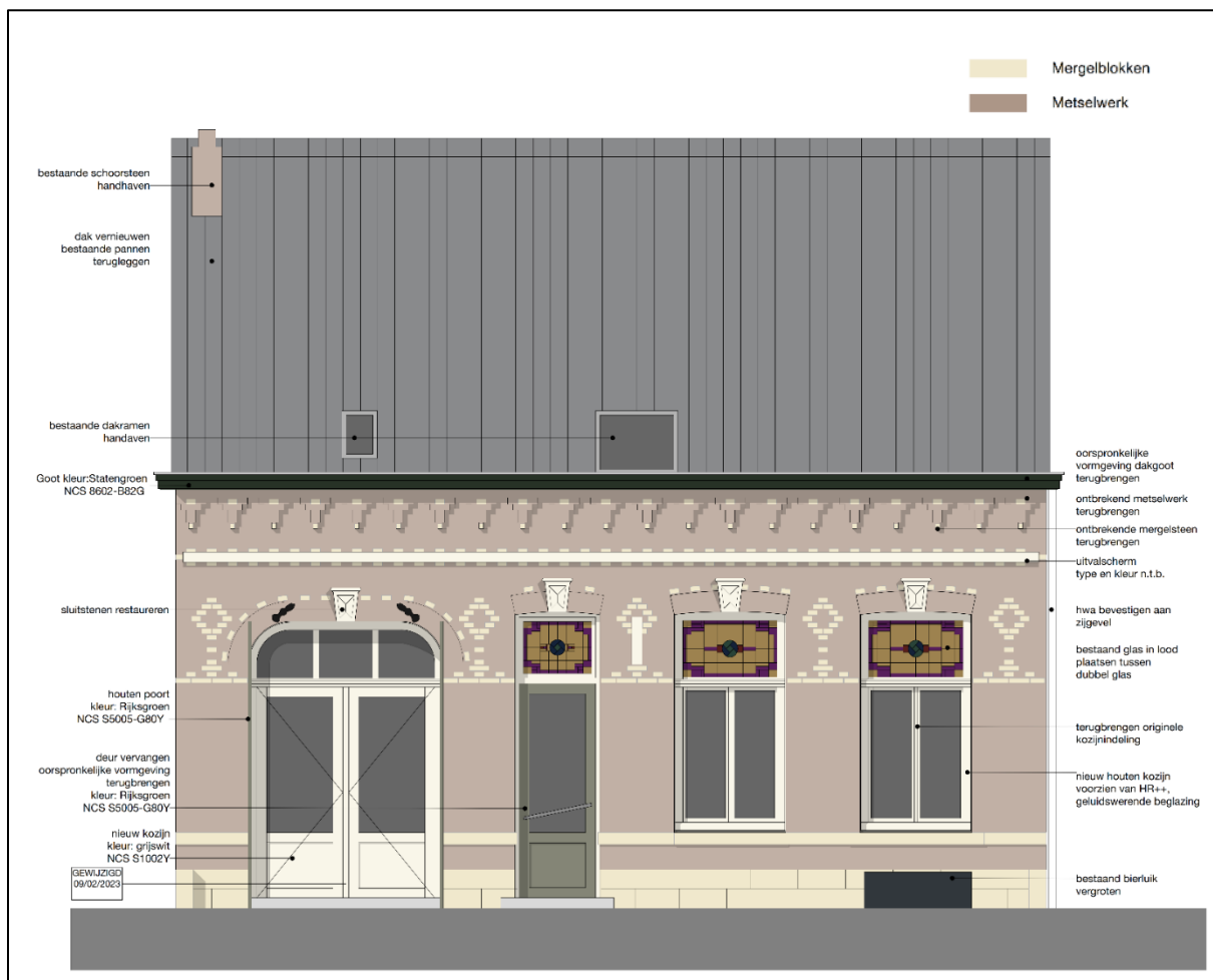
Afbeelding 13: Restauratieplan voorgevel. Bron: Artesk van Royen Architecten.
